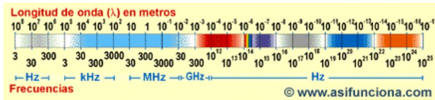
*Espectro completo de las radiaciones de ondas electromagnéticas.*
