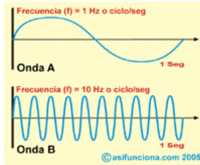
**A.-** Onda senoidal de un ciclo o hertz (Hz) por segundo. **B.-** Onda senoidal de 10 ciclos o hertz por segundo.
